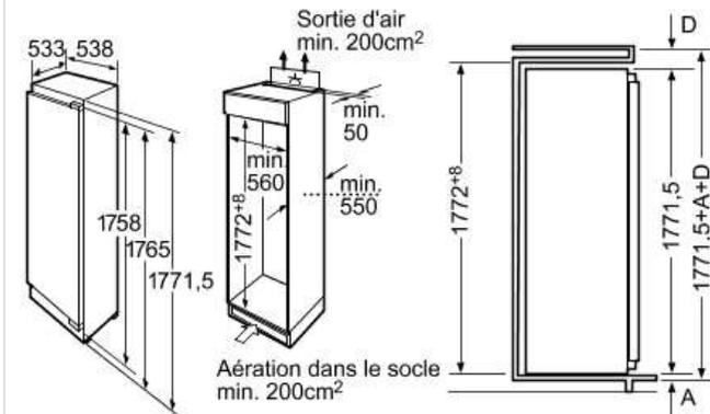
En cas de dimensions de niche plus grandes (1780-1790) prévoir une baguette de compensation au plafond de la niche : peut aussi être commandée comme baguette plastique blanche sous la réf. de pièce de rechange 438172
