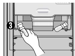
Remplacer les lampes et effectuer les opérations inverses pour le remontage
