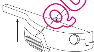
Hvis kjøleskapet er utstyrt med et øvre lys som vist under (figur A eller figur B), skal man utføre trinnene over for å skifte lyspæren: ta av det gjennomsiktige beskyttelsesdekslet med et skrujern, og utvid vingene. Skift ut lyspæren, sett på plass beskyttelsesdekslet igjen og slå på kjøleskapet.
