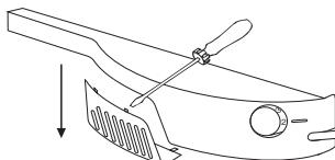
Vyšroubujte žárovku a vyměňte ji za žárovku stejného typu a stejněho výkonu.
