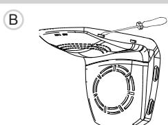
Σε προϊόντα με τεχνολογία πλήρως αυτόματης απόψυξης (TOTAL NO FROST), στο κάτω μέρος του χώρου συντήρησης μπορεί να υπάρχει μια στήλη που περιέχει λυχνίες LED, η οποία υπάρχει μόνο σε προϊόντα με σύστημα ελέγχου ηλεκτρικού τύπου και όχι σε προϊόντα με σύστημα μηχανικού τύπου. Σε περίπτωση βλάβης των λυχνιών LED ή μη σωστής λειτουργίας, απευθυνθείτε στο κέντρο τεχνικής υποστήριξης.
