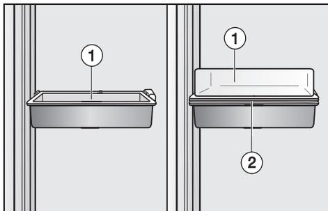
La boîte amovible est composée d'un bac profond ① et d'un bac plat ② - les deux bacs peuvent être insérés dans le cadre en inox.
