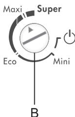
Pour mettre l'appareil en marche, tournez le bouton du thermostat (B) vers la position **Maxi** ; pour le mettre à l'arrêt, positionnez le curseur en face de l'icône Marche/Arrêt
