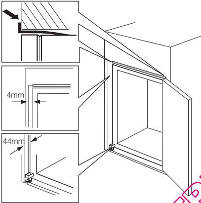
4. Fixez l'appareil au meuble d'encastrement à l'aide de 4 vis.
