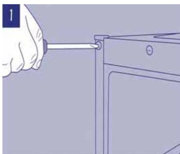
Retirer les caches-vis positionnées à l'extérieur de l'appareil.
