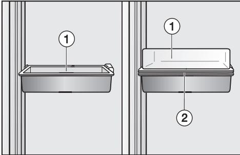
Il est constitué d'un bac profond ① et d'un bac plat ② qui peuvent tous deux être installés dans cadre de support en inox.
