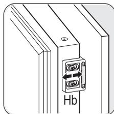
Placez à nouveau la petite équerre sur le guide et fixez-la à l'aide des vis fournies. Aalignez la porte du meuble de cuisine et la porte de l'appareil en ajustant la position des trous.
