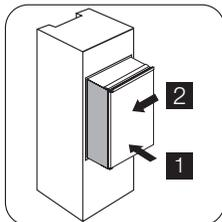
Insérez l'appareil dans le meuble d'encastrement. Poussez l'appareil dans le sens indiqué par les flèches (1) jusqu'à ce que le cache de l'ouverture supérieure bute sur le meuble de cuisine. Poussez l'appareil dans le sens indiqué par les flèches (2) contre le meuble, dans le sens opposé aux charnières.
