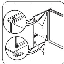
Fixez l'appareil au meuble d'encastrement à l'aide de 4 vis.
