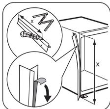
Si nécessaire, coupez la bande isolante adhésive et appliquez-la sur l'appareil, comme illustré sur le schéma.
