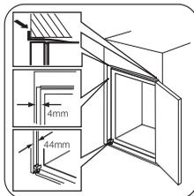
Positionnez l'appareil dans le meuble d'encastrement.
