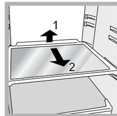
**RIPIANI:** pieni o a griglia. Sono estraibili e regolabili in altezza grazie alle apposite guide (vedi figura), per l'inserimento di contenitori o alimenti di notevole dimensione. Per regolare l'altezza non è necessario
