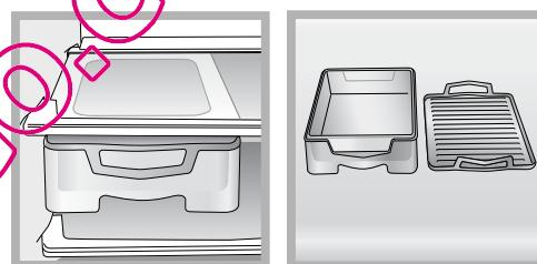
Indicateur de **TEMPERATURE**: pour repérer la zone la plus froide à l'intérieur du réfrigérateur.
