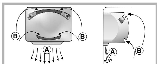
A Wind Pure Plus maximális mértékben optimalizálja a levegőkeringést, ezáltal növeli a párologtató hatékonyságát, azaz hozzájárul ahhoz, hogy a hűtőgép belsejében a hőmérséklet az ajtónyitogatások után gyorsabban helyreálljon.
