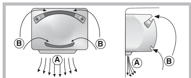
Pure Wind Plus optimiza al máximo la circulación del aire, mejorando la eficiencia del evaporador y contribuyendo a alcanzar con mayor rapidez la temperatura adecuada dentro del frigorífico luego de suertura. El aire ventilado (A) se enfria en contacto con la pared fría, mientras que el aire más caliente (B) se aspira (ver *la figura*).
