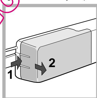
Odmontować zabezpieczenie, aby dojść do żarówki i tak jak wskazano na rysunku. Wymienić na żarówkę o mocy takiej, jaką jest wskazana na zabezpieczeniu (15 W lub 25W).
