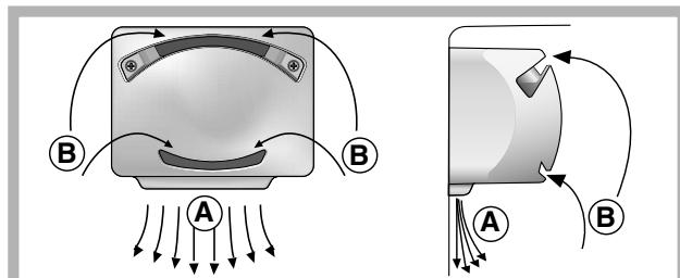
Pure Wind Plus maksymalnie optymalizuje cyrkulację powietrza, zwiększając skuteczność parownika i umożliwiając szybsze osiągnięcie właściwej temperatury wewnętrz lodówki po każdym jej otwarciu. Dmuchane powietrze (A) chłodzi się po zetknięciu z
