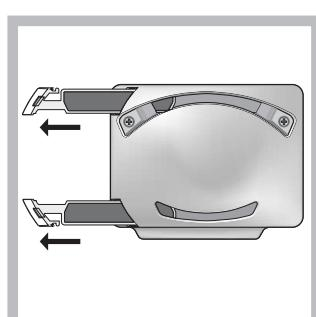
Laisser sécher soigneusement avant de remettre les filtres en place. Si les filtres ne sont pas extractibles, ou s'il est particulièrement difficile de les démonter, contacter le service d'assistance technique.
