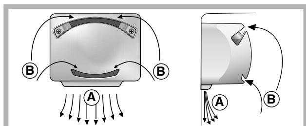
Wind Pure ottimizza al massimo la circolazione dell'aria, migliorando l'efficacia dell'evaporatore e contribuendo a raggiungere più rapidamente la giusta temperatura all'interno del frigo dopo ogni apertura. L'aria soffiata (A)
