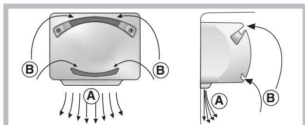
Pure Wind PLUS optimiza ao máximo a circulação do ar, melhorando a eficácia do evaporador e ajudando a alcançar mais rapidamente a temperatura correcta no interior do frigorífico após cada abertura.
