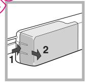
Accedere alla lampada togliendo la protezione come indicato in figura. Sostituirla con una analoga di potenza a quella indicata sulla protezione (15 W o 25 W).
