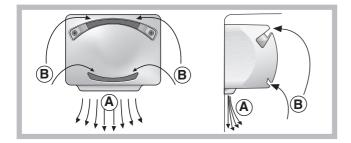
Pure Wind Plus optimiza al máximo la circulación del aire, mejorando la eficiencia del evaporador y contribuyendo a
