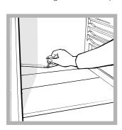
apposito foro di scarico (vedi figura) dove il calore prodotto dal compressore la fa evaporare. L'unico intervento da fare periodicamente consiste nel pulire il foro di scarico affinché l'acqua possa defluire liberamente.
