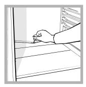
envía hacia la parte posterior por un orificio de descarga (ver la figura) donde el calor producido por el compresor la hace evaporar. La única intervención que se debe realizar periódicamente consiste en limpiar el orificio de descarga para que el agua pueda fluir libremente.
