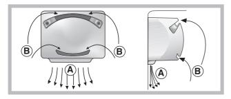
Pure Wind PLUS optimiza ao máximo a circulação do ar, melhorando a eficácia do evaporador e ajudando a alcançar mais rapidamente a temperatura correcta no interior do frigorífico após cada abertura.
