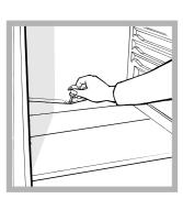
de um furo de descarga (veja a figura) desta maneira o calor produzido pelo compressor evaporase. A única intervenção a ser realizada periodicamente consiste na limpeza do furo de descarga para a água poder defluir desimpedida.
