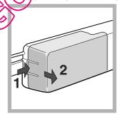
Para obter acesso à lâmpada, retire a protecção da maneira indicada na figura. Substitua-a por uma de potência análoga à indicada na protecção (15 W o 25 W).
