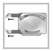
(cada 12-18 meses) los filtros bajo agua corriente y con detergente neutro para quitar posibles residuos depositados. Dejar secar bien antes de volver a montar los filtros en su asiento. Si los filtros no son extraíbles o si es difícil su extracción, contacte la asistencia técnica.
