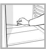
un trou d'évacuation (voir figure) où la chaleur produite par le compresseur la fait évaporer. Il vous suffit de nettoyer périodiquement le trou d'évacuation pour permettre à l'eau de s'écouler normalement.
