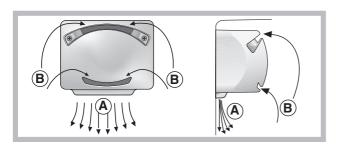
Pure Wind Plus qui optimise au maximum la circulation de l'air, améliore l'efficacité de l'évaporateur et contribue à rétablir très rapidement la température à l'intérieur du réfrigérateur après chaque ouverture. L'air soufflé (A) refroidit au contact de la paroi froide, tandis que l'air plus chaud (B) est aspiré (voir figure).
