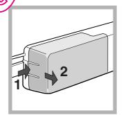
Acceda a la lámpara quitando la protección como se indica en la figura. Sustitúyala con otra bombilla con una potencia igual a la indicada en la protección (15 W o 25 W).
