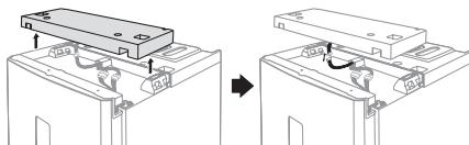
**ACHTUNG** Elektrische Kabel beim Abnehmen der Kunststoffabdeckung nicht beschädigen.
