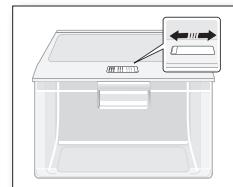
Je weiter Regler nach rechts geschoben wird, umso höher wird Luftfeuchtigkeit im Fach. Mit steigender Anzahl der Lüftungsöffnungen steigt auch proportional die Luftfeuchtigkeit im Fach an.
