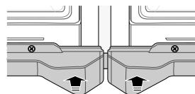
7. Verbinden Sie die untere Befestigung B mit den Schrauben an der Rückseite der Geräte.
