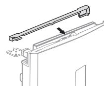
15. Retirez la poignée du côté gauche, pour la placer à droite. (Assurez-vous pour couvrir le côté droit avec les bonnets détachés.)
