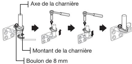
8. Fixez la charnière sur la partie inférieure gauche du réfrigérateur, à l'endroit où se trouvaient les boulons retirés à l'étape 6. Vissez les boulons sur la partie inférieure droite du réfrigérateur pour pouvoir les réutiliser en cas de besoin.
