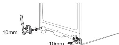
7. Schroef de bout los om het metalen stuk te verwijderen. Verwijder de scharniersas met de inbussleutel en zet de scharniersas en het metalen stuk aan de andere kant.
