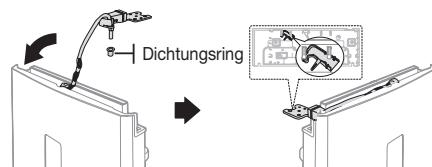
14. Befestigen Sie die Kabelabdeckung nach dem Umsetzen des Scharniers auf der Oberseite der Kühlzanktür.
