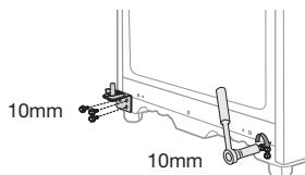
9. Lösen Sie die Schrauben an der unteren linken und rechten Seite der Gerätetür. Setzen Sie den Türdämpfer von rechts nach links um.
